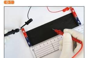
テスターの黒端子は-極に固定したまま、赤 端子を導電ゴム上にあて、テスターの電圧値 が 03 で計測した値の 1/10 となる位置を探します。 (例えば、電池の電圧が 2.7V の場合は 0.27V とな る位置を探します)目的の位置を発見したら、その位 置に赤端子を軽く突き刺し、導電ゴム上に印を付けま す。次に、導電ゴム上で目的となる別の位置を探し、 同様に印をつけてください 7-1 。これを繰返すと、 どのようなことがわかりますか?
