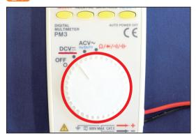
事前準備として電源(電池)の電圧を測定し ます。棒磁石の両端の電圧を測り、2.4~ 2.8V 程度であることを確認します。満充電時の電圧 から大きく電圧が降下している場合は、電池を充電し ましょう 3-1。
