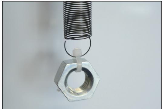
この状態でバネの長さ（ $l$ ）を計測します。 2-2 バネの長さ  $l$  は、L型金具からおもりであるナットの上端までの長さとしてます。
