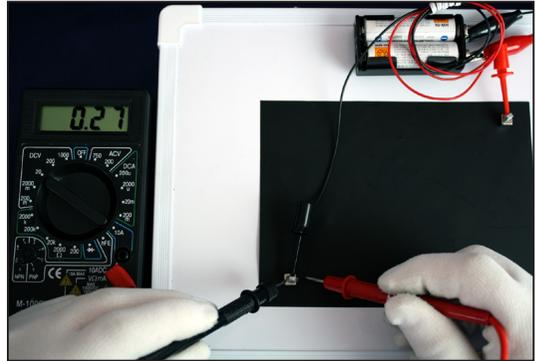
**04** **03** に引き続いて実験を行います。この実験では電源電圧の  $1/10$  値の 2 倍、3 倍、4 倍… 9 倍の値が見つかる地点を探してください。例えば電源電圧の  $1/10$  値が  $0.27\text{V}$  の場合は **4-1** 表のように計算し、これらの電圧値となる地点を探します。二つの電極から描かれた等電位線（同じ値の印を結んだ線）は、どのような形になりましたか？
