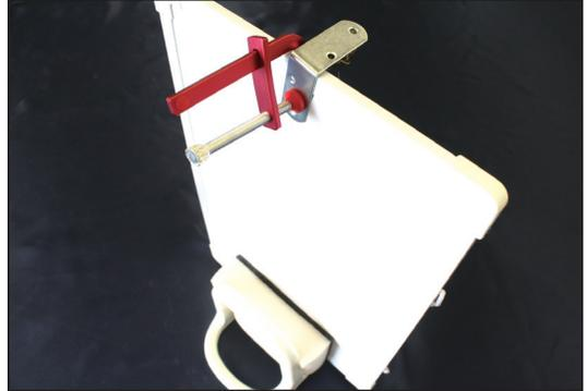
**02** 振り子部分をセッティングしましょう。まずはものさしを使って振り子の糸の長さが20cm程度になるように測り、フェライト磁石で挟みます。**2-1** 「振り子の糸の長さ」とは、金属球の中心からフェライト磁石の端までの長さのことです。
